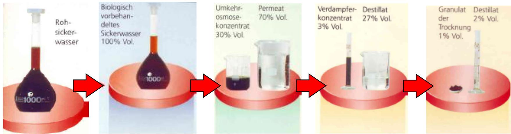
Rohsickerwasser      Biologie / Ultrafiltration      Umkehrosmose      Verdampfung      Trocknung
