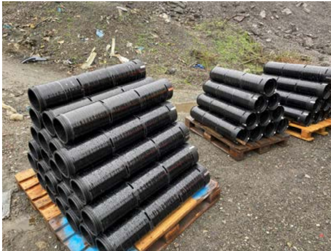
Relining-Kurzrohre aus PE100 mit Basaltummantelung
